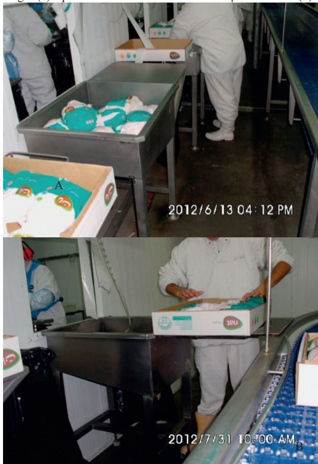
Figura 1: Adequação de um posto de trabalho no setor de frango inteiro - manuseio de caixas, rotação do tronco com manuseio de cargas (a) e posicionamento de cubas sem rotação de tronco (b)
